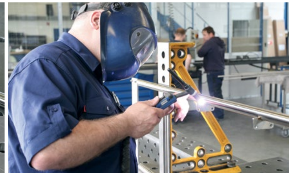
Positionierung der Stufenlaschen durch punktuell Anschweißen
