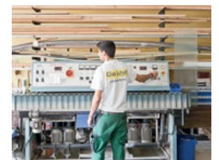
8-Spindel-Schleifautomat für schnelle Kantenbearbeitung
