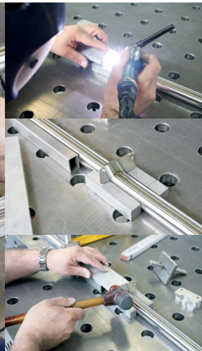
Positionierung der Stufenlaschen durch punktuell Anschweißen
