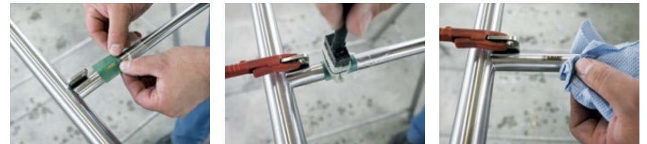
Nach dem Vliesen wird das MWE-Logo auf die Strebe geätzt.
