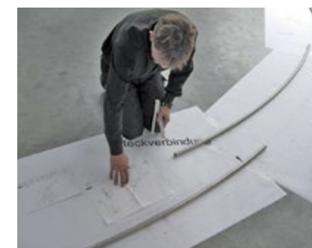
Der gefertigte Laufschienebogen wird bei der Montage passgenau auf der Technikzeichnung ausgelegt und mit ihr abgeglichen.
